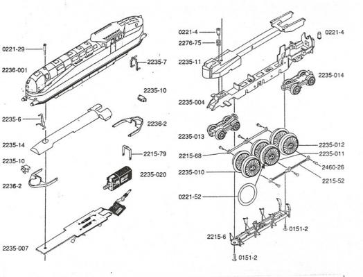
Für das Befahren der beiden kleinen Gleisradien R 192 mm und R 222 mm und bei Verwendung der beiliegenden Kupplungshaken , ist das Entfernen der Scharfenbergkupplungsattrappen und der Schürzen an beiden Enden der Lok erforderlich.
